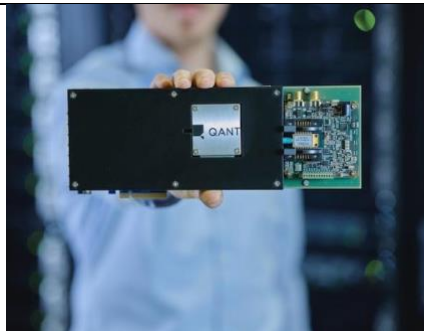
Bildunterschrift: Photonischer Prozessor auf PCI-Express: Die Q.ANT NPU ist für rechenintensive Anwendungen wie KI-Inferenz, maschinelles Lernen und Physiksimulationen konzipiert. (Bild: Q.ANT GmbH)
